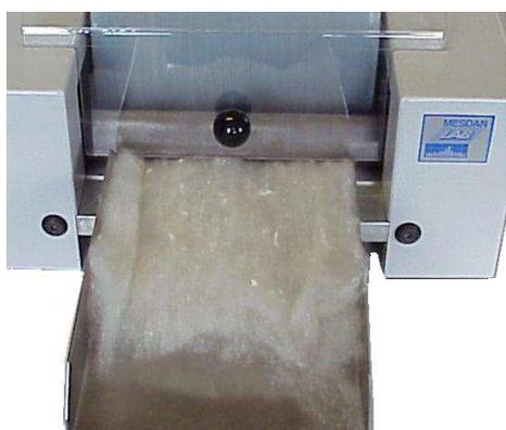
Mini carda per laboratorio per la preparazione di un campione omogeneo e pulito di cotone sodo da utilizzare con il NATI per l'analisi del contenuto dei neps.
