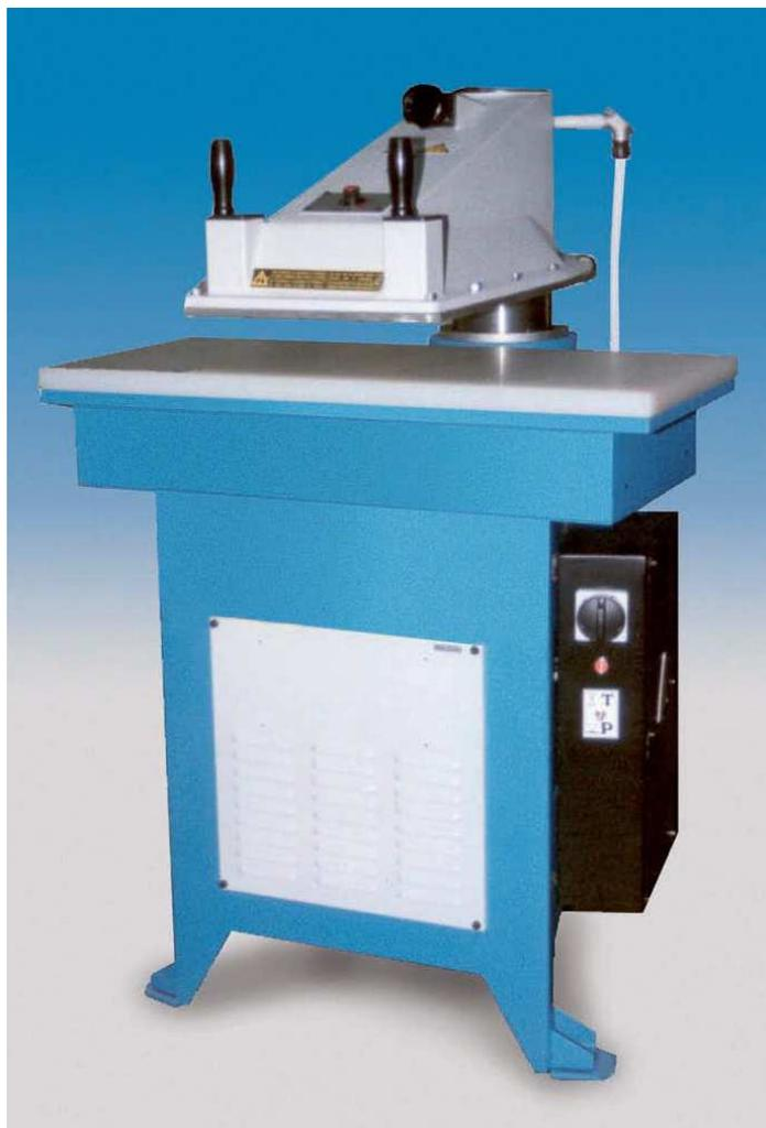
La pressione di taglio e la luce sono regolate dall'operatore in base allo sviluppo (lunghezza di taglio) della lama della fustella utilizzata, alla sua altezza e allo spessore del materiale. La macchina gestisce automaticamente la corsa di taglio.
