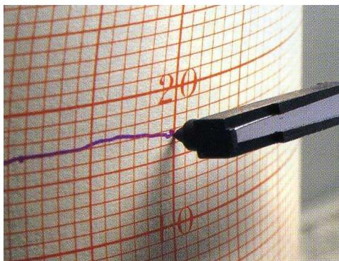
Strumento per rilevare e registrare la temperatura e l'umidità relativa percentuale dell'aria (RH%) su apposita carta diagrammata avvolta su di un tamburo rotante.
