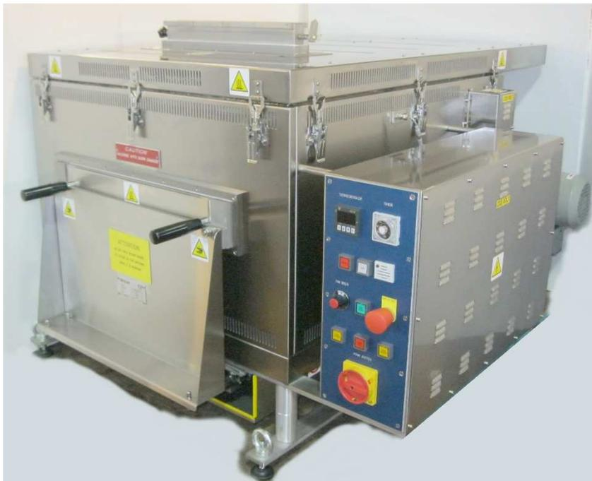
Piccola RAMEUSE in miniatura, adatta per l'asciugatura dei campioni di tessuto tinto, in particolare per il fissaggio del tessuto a caldo.
