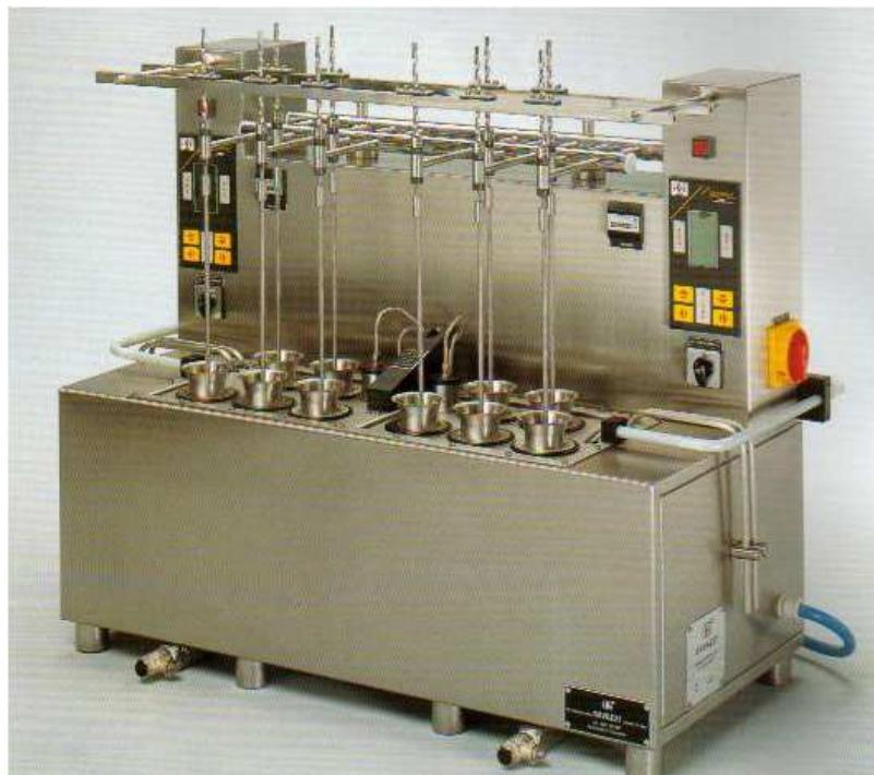
Apparecchio da laboratorio per la tintura atmosferica (max +98°C) di fibre tessili naturali, sintetiche e miste, sia in pezza, fiocco, matassa, con procedimento per esaurimento del bagno. Con due vasche di riscaldamento a bagnomaria indipendenti pilotate ciascuna da un microprocessore.
