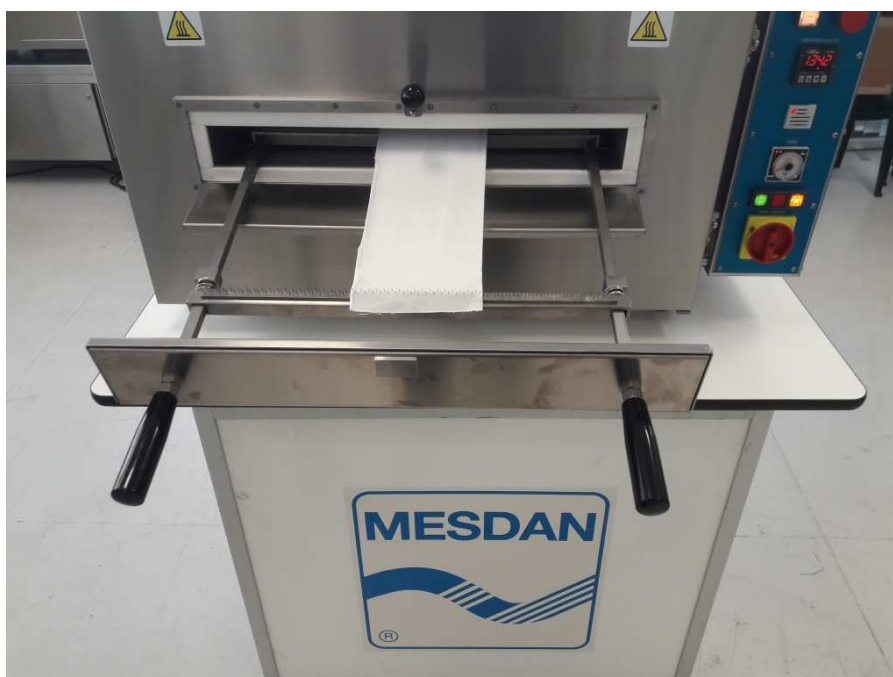
3106B detail of a piece of fabric specimen onto the standard sample holder. 3106B particolare del tessuto montato sul telaio portacampioni standard.
