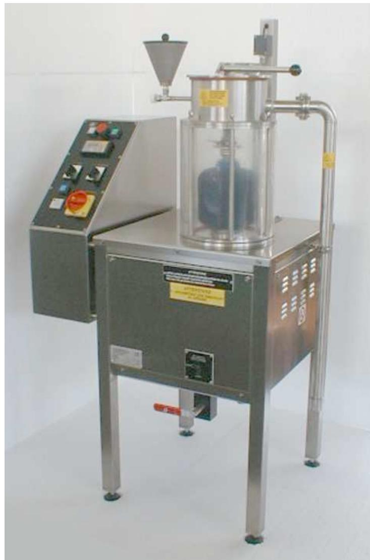
Apparecchio da laboratorio di tipo universale adatto per la tintura atmosferica (+98°C) di fibre, filati, tessuti, naturali, sintetici e in mista. Strumento dotato di innovativo sistema di riscaldamento elettrico
